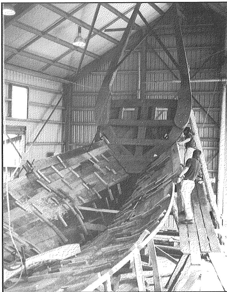
På gården utanför Western Australia Maritime Museum pågår byggandet av 1600-talsfartyget Duyfsken . I september 1997 hade man börjat lägga i bottenstockarna och hunnit lägga ca tio bordläggningssvarv. Foto: Göran Ekberg.
