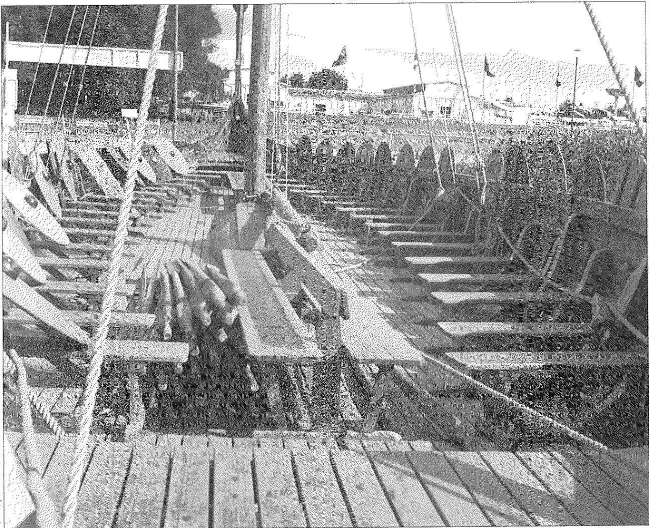
Figur 2. Ormen Friske (ovan) var kopierad efter det norska Gokstadskeppet, som är 23,2 m långt och har en största bredd av 5,2 m. Deplacementet har beräknats till strax över 20 ton.
