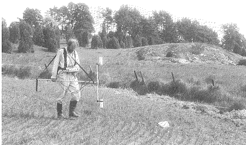
Bild 4. Gerhard Schwartz mäter med cesiummagnetometern i åkermarken.
