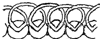
Slanbyggd båtbottnen med inv. repsurrning.
